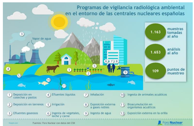
Figura 12. Esquema PVRA. Fuente Foro Nuclear. Datos C.N.Cofrentes 2023.
