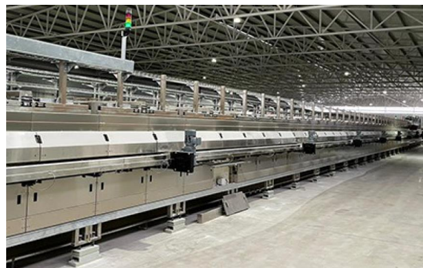
Figura 5. Esquema de la sección del horno eléctrico (izquierda) y fotografía del horno eléctrico instalado en KERAJet (derecha), Fuente: KERAJet.
